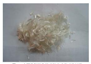
图 2-1 表面作膨胀化处理的玄武岩矿物纤维 1
